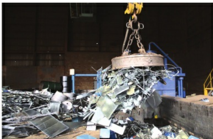
92-сурет. Электрмагнитті кран
