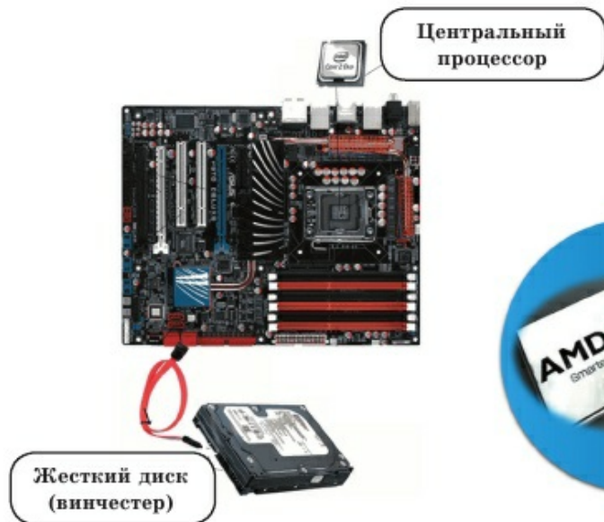
Рис. 4. Процессор и жесткий диск на системной плате
