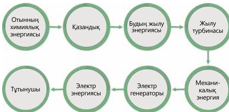
109-сурет. ЖЭС-ғы өндірістің кезеңдері
