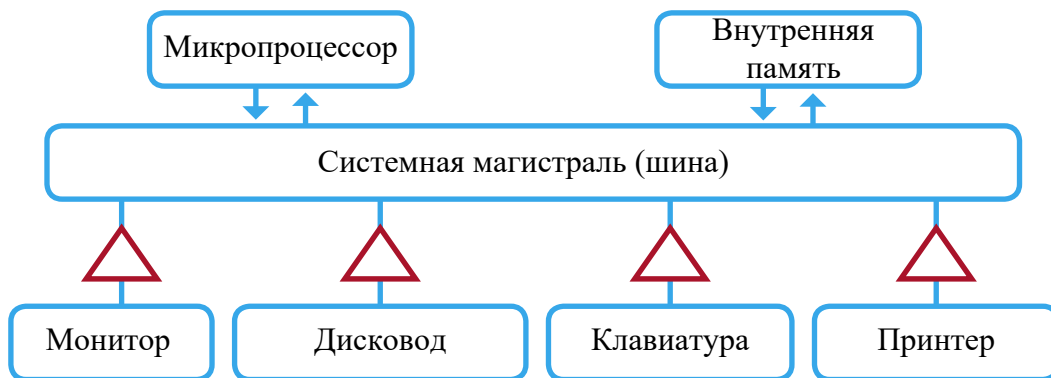
Рис. 13. Структура персонального компьютера (треугольники – контроллеры)
