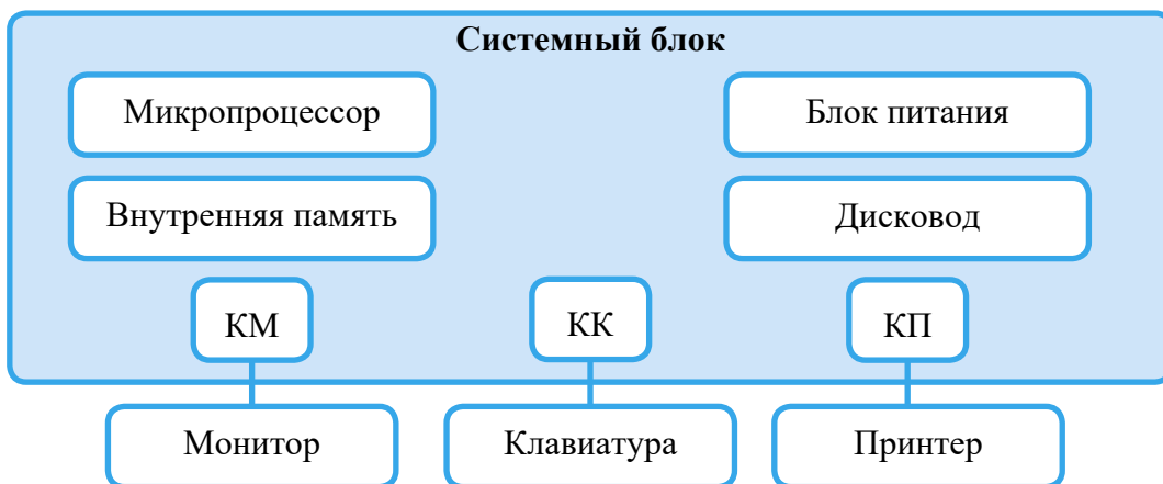
Рис. 12. Минимальный комплект устройств компьютера (КМ – контроллер монитора, КК – контроллер клавиатуры, КП – контроллер принтера)
