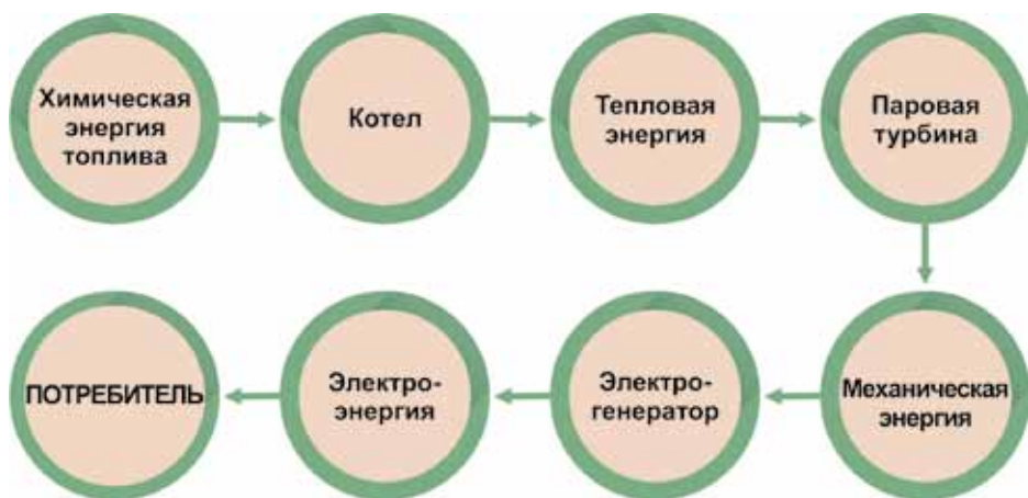
Рис. 100. Производственные стадии работы ТЭС
