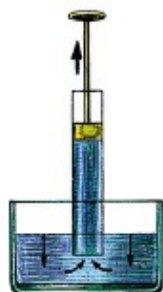
Сурет 4.30. Атмосфералық қысымның әрекетінен су поршеньмен ілесе жоғары көтеріледі
