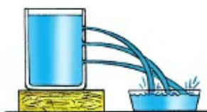
Сурет 4.18. Ыдыстың төменгі шүмегінен шыққан сұйық алысқа шапшиды
