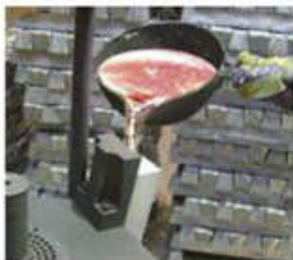
52-сурет. Павлодар металлургиялық комбинатында алюминийді қалыпқа құю процесі
