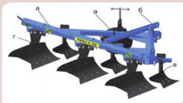
Аспалы соқа: а – шанақ; ә – бұрама механизмі бар тірек доңғалағы; б – соқа аспасының бағаны; в – шолақсоқа; г – соқажинақ (негізгі)
