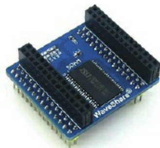
Рис. 1.6. Кэш-память в виде отдельной высокоскоростной микросхемы
