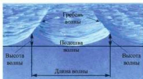
Рис. 56. Схема строения ветровой волны
