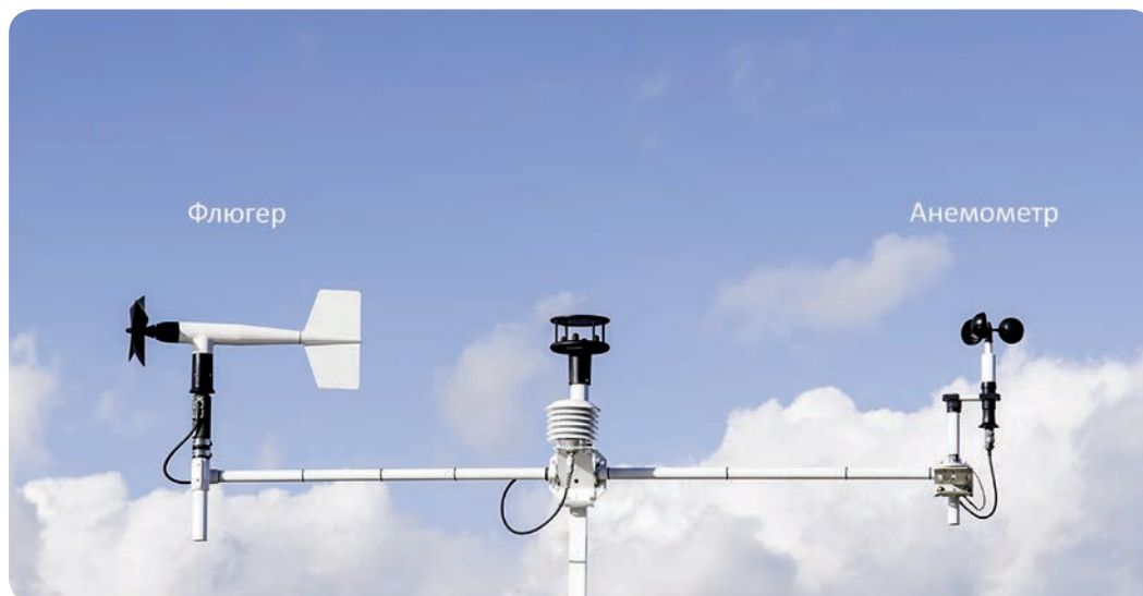
Рис. 78. Приборы, измеряющие силу и направление ветра
