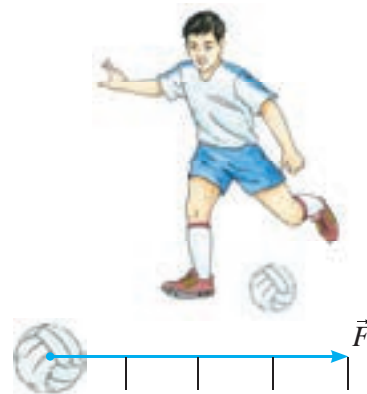
Рис. 39. Изображение силы, действующей на мяч
