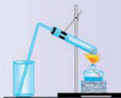
Рис. 24. Прибор для получения кислорода
