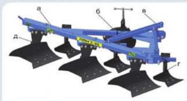
Навесной плуг: а – рама; б – опорное колесо с винтовым механизмом; в – стойки навески плуга; г – предплужник; д – корпус плуга
