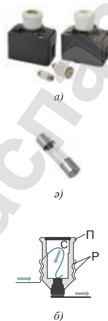
127-сурет. Балқымалы сақтандырғыштың құрылысы
