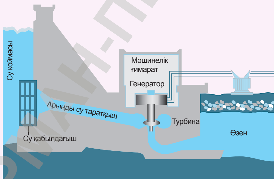
174-сурет. Су турбинасы генератор білігін айналдырады
