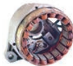
172-сурет. Зәкір – генератордың сыртқы орамасы
