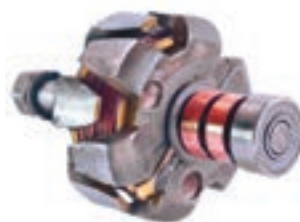
171-сурет. Индуктор – генератордың ішкі орамасы
