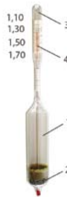
53-сурет. Өлшемдері көрсетілген ареометр: 1 – шыны бөлігі; 2 – ұсақ металл (Pb) салынған төменгі бөлігі; 3 – түтік; 4 – шкала
