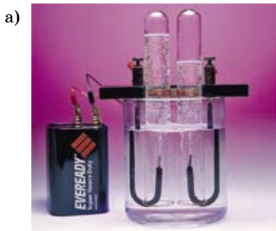
23-сурет. Суды электр тогымен айыру құралы (а) және сутегін зертханада алу (б)
