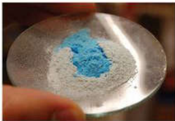
87-сурет. Мыс (II) сульфатының көмегімен суды анықтау
