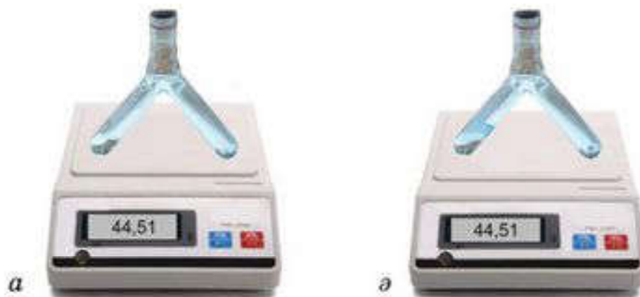
17-сурет. Зат массасының сақталу заңын тәжірибе жүзінде дәлелдеу: а — тәжірибеге дейін, ә — тәжірибеден кейін
