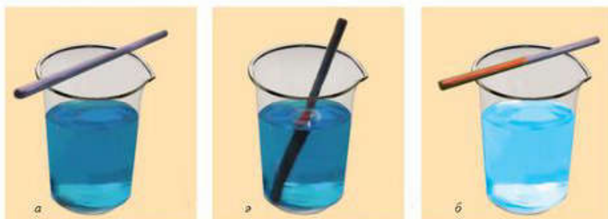
21-сурет. Мыс тұзының ерітіндісінде темір мыстын орнын басады: а — реакцияға дейін; б — реакция барысында; в — реакциядан кейін
