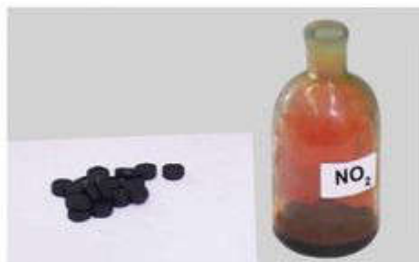
80-сурет. а — \text{NO}_2 ерітіндісін ағаш көмірімен адсорбциялау; ә — көмір сүзгілер
