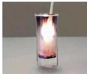
Рис. 33. При разложении \text{H}_2\text{O}_2 выделяется кислород, что можно доказать с помощью тлеющей лучинки. Что происходит?
