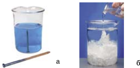
Рис. 11. Металлическая медь покрывает железный гвоздь (а); Образование осадка хлорида серебра AgCl (б)
