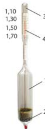
Рис. 56. Строение ареометра: 1 – стеклянный корпус; 2 – крупинки металла (Pb); 3 – трубочка; 4 – шкала
