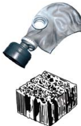
Рис. 69. Противогаз и адсорбент – активированный уголь под микроскопом
