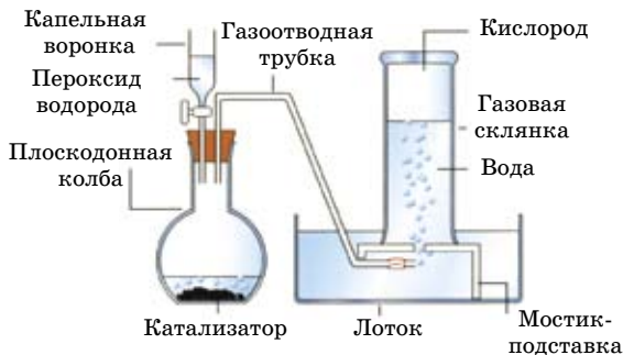
Рис. 30. Получение кислорода разложением пероксида водорода
