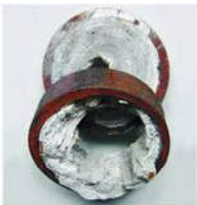
Рис. 89. Накипь в трубах
