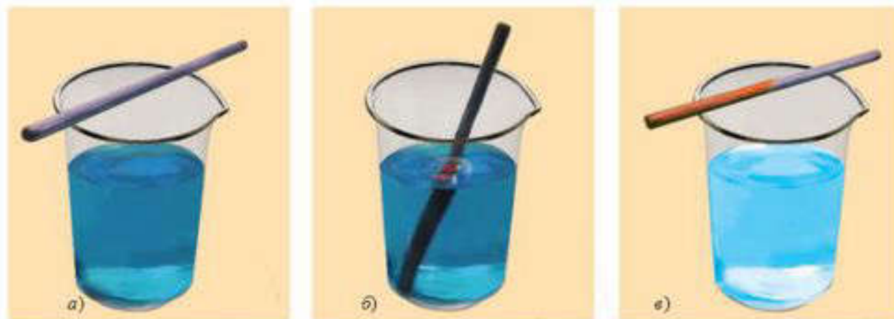
Рис. 21. Реакция замещения железом меди из ее соли: а) до реакции; б) во время реакции; в) после реакции
