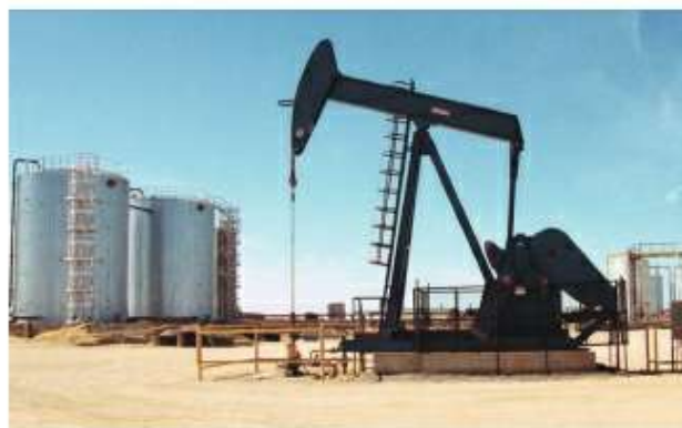
50-сурет. Мұнай кәсіпшілігі (Бозащы). Ең алдымен мұнай бұрқақ түрінде атқылайды. Бұрқақ басылған кезде тербелмелі станок іске қосылады. Ол мұнай айдайтын насосы қозғалысқа келтіреді
