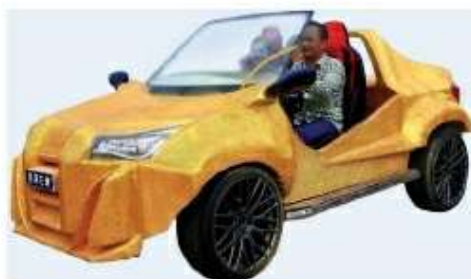
214-сурет. Қытайда 3D принтері арқылы шығарылған әлемдегі бірінші автомобиль. Бұл үшін 5 күн және 1000 доллар қажет болды
