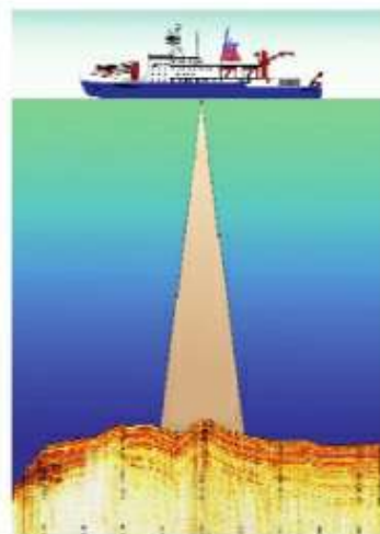
Сурет 5.32. Эхолотпен теңіз түбін зерттеу
