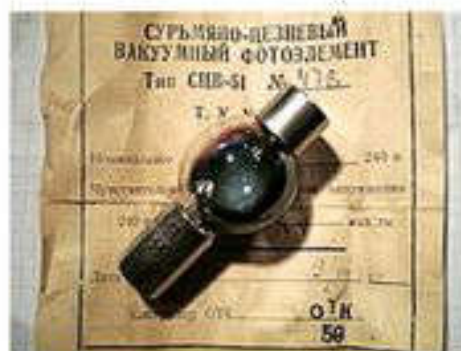
39.2-сурет. Сыртқы фотоэффект құбылысы қолданылатын сурьма-цезийлі фотоэлемент
