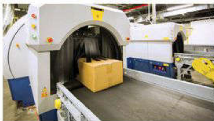
41.3-сурет. Рентген теледидарлық интроскоп
