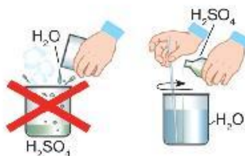
54-сурет. Күкірт қышқылының ерітіндісін дайындау
