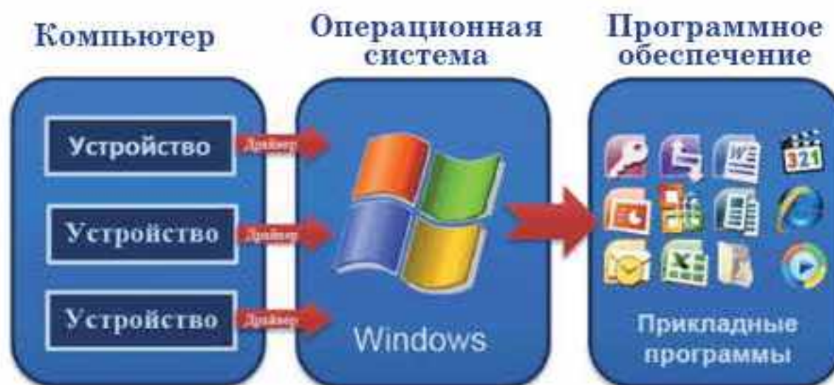
Рис. 2.6. Схема взаимодействия программного обеспечения компьютера
