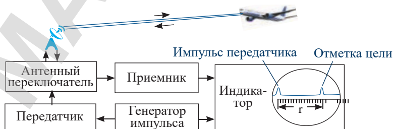
Рис. 193. Определение расстояния до объекта по интервалу между переданным и принятым радиолокатором сигналом
