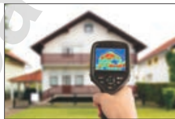
Рис. 197. Исследование тепловых потерь жилого дома с использованием тепловизора
