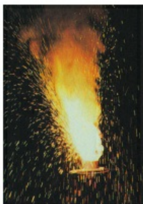
Рис. 24. Алюмотермия. Восстановление железа из оксида алюминием
