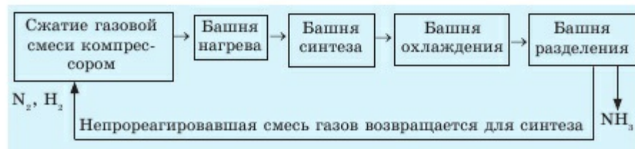
Схема 3. Технологическая схема производства аммиака
