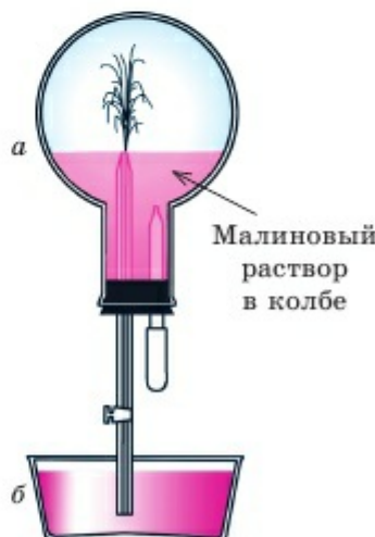
Рис. 34. Растворение аммиака в воде: а – склянка с газобразным аммиаком; б – кристаллизатор с водой и фенолфталеином
