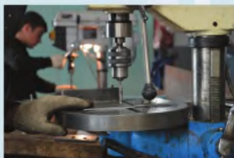
Работа на сверлильном станке
