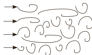
73-сурет. Турбуленттік ағыс кезіндегі ағын сызықтары
