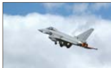
91-сурет. Асқындыбысты жылдамдық кезінде ұшақтың алдыңғы бөлігіне қапталдай ауға ыңғайлы пішін берілген
