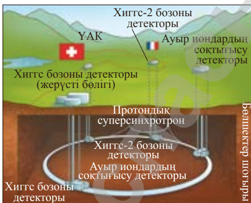
289-сурет. Үлкен адрондық коллайдер (YAK) құрылысының принциптік сұлбасы
