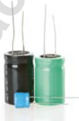
187-сурет. Металқағазды және алюминийлі электролиттік конденсатор
