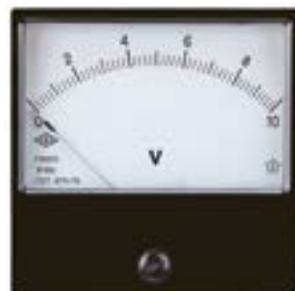
4-сурет. 2-дәлдіктегі класқа жататын вольтметр шкаласы
