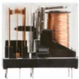
319-сурет. Электромагниттік реле
