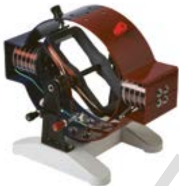
337-сурет. Мектеп зертханасына арналған электрқозғалтқыш моделі
