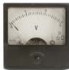
6-сурет. Дәлдік класы 2,5 болатын зертханалық вольтметр
