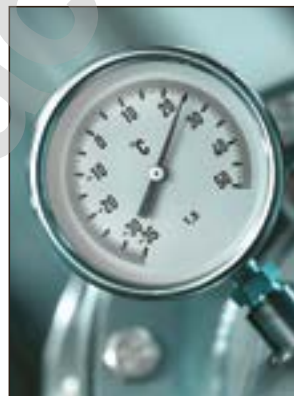
102-сурет. Механикалық термометрдің шкаласы
