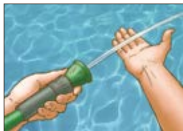
72-сурет. Ламинарлық ағыс кезінде ағын түтігінің қимасының ауданы сақталады
