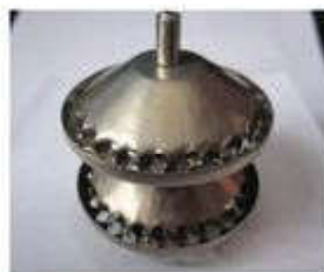
123-сурет. Ректификациялық мұнарадағы тәрелкелер
