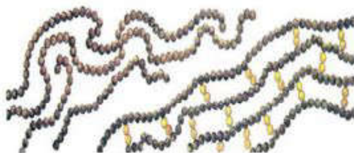
107-сурет. Вулканизацияланған көксағыздың құрылыс сызбасы
