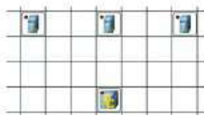
Рис. 1.2.6. Схема с тремя компьютерами и концентратором
