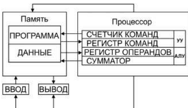
Рис. 2.5.1. Общая схема компьютера
