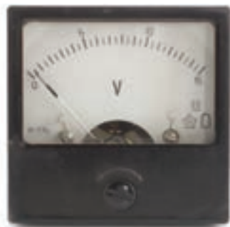
Рис. 6. Лабораторный вольтметр класса точности 2,5
