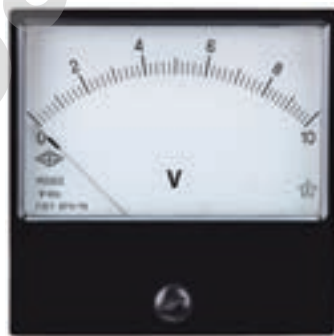
Рис. 4. Шкала вольтметра с классом точности 2
