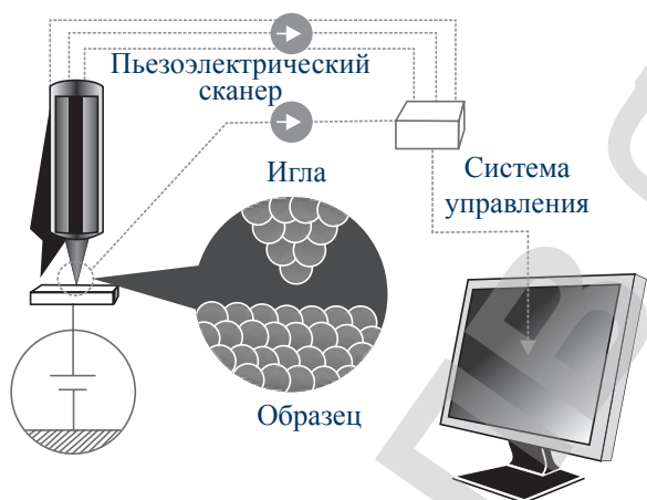
Рис. 96. Принцип действия туннельного микроскопа
