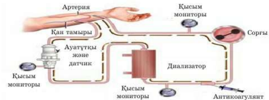
31-сурет. Жасанды бүйрек қызметінің сызбасы
