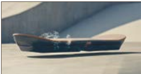
189-сурет. Магниттік левитация құбылысына негізделген ховерборд, 2005 ж.
