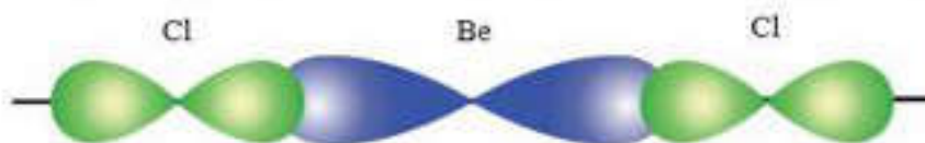
18-сурет. BeCl_2 молекуласындағы электрондық бұлттардың бүркесуі
