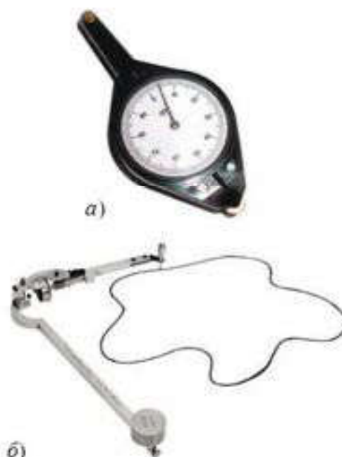
Рис. 8. Картографические приборы: а) курвиметр ; б) планиметр
