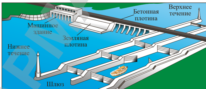
Рис. 62. Принципиальная схема шлюза
