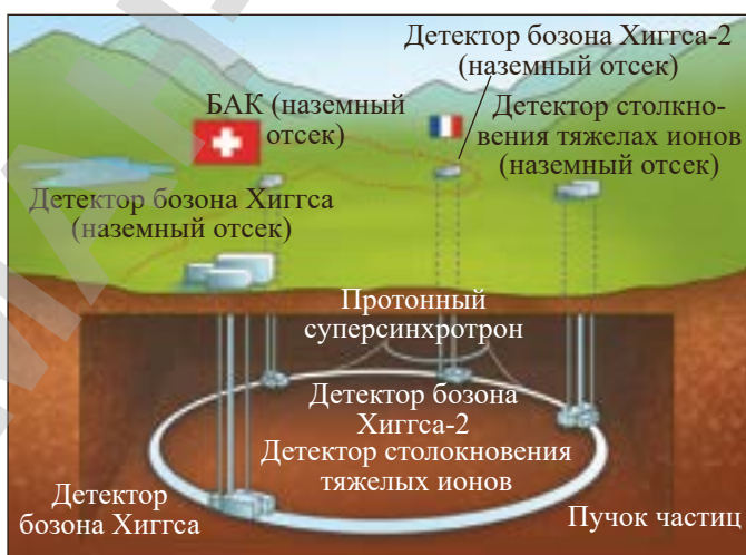
Рис. 214. Принципиальная схема устройства Большого адронного коллайдера
