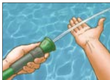
Рис. 84. При ламинарном течении площадь сечения трубки тока сохраняется
