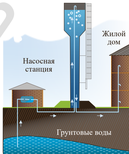
Рис. 58. Водопровод с водонапорной башней
