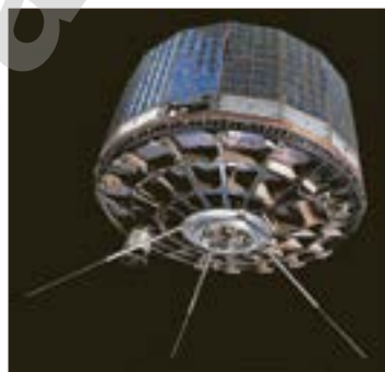
Рис. 19. Первый метеорологический спутник Земли TIROS
