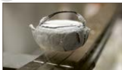
Рис. 188. Взаимодействие сверхпроводника с рельсами из постоянного магнита
