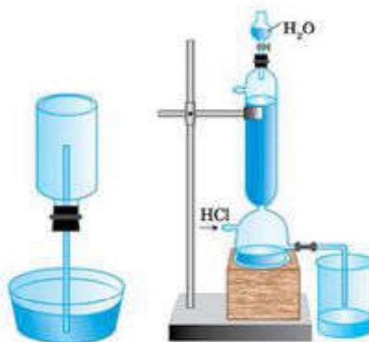
Рис. 105. Растворение хлороводорода в воде
