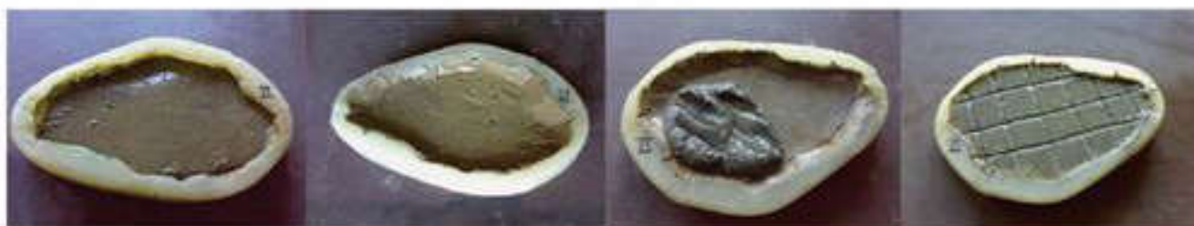
Рис. 129. Этапы затвердевания цемента
