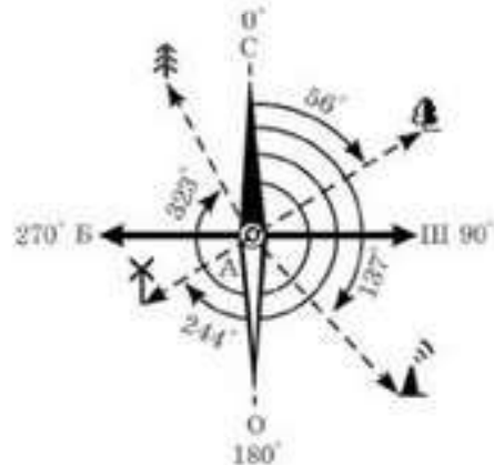
55-сурет. Магниттік азимуттар: жанырақты ағашқа – 56^\circ ; фабрика трубасына – 137^\circ ; дпйрменге – 244^\circ ; шыршаға – 323^\circ
