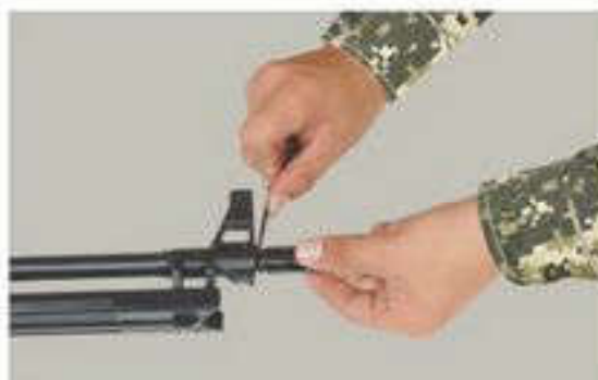
10, ә-сурет. Пулеметтен жалын сөндіргішін бөліп алу
