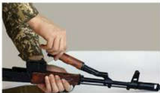
15, б -сурет. Ұңғылық бастырмасымен газ түтігін босатып алу
