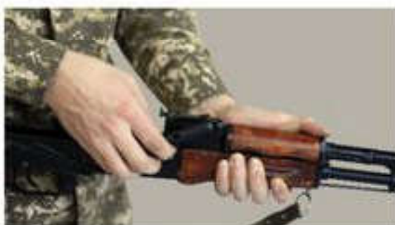
15, a -сурет. Газ түтігі жапқышын керек-жарақ пеналының көмегімен бұрау
