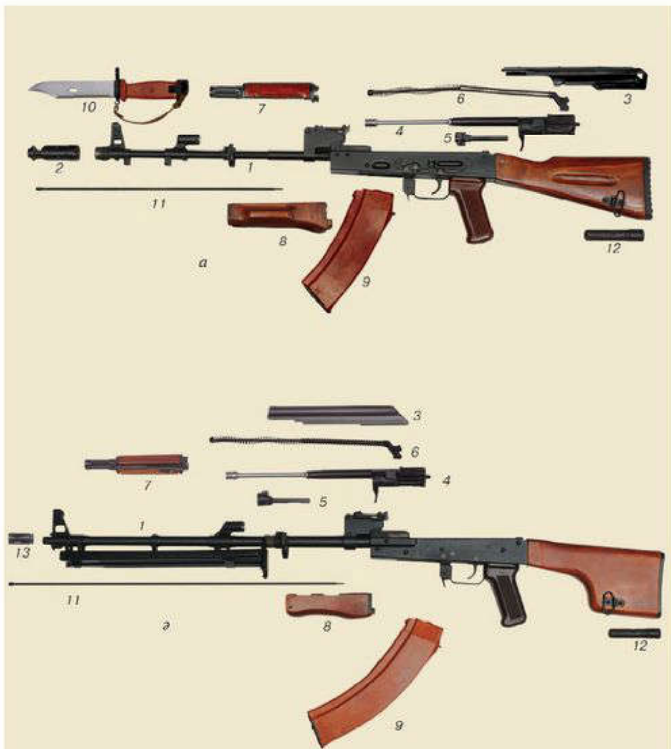
6-сурет. Автоматтың (пулеметтің) негізгі бөліктері мен механизмдері және оның жабдықтары:
