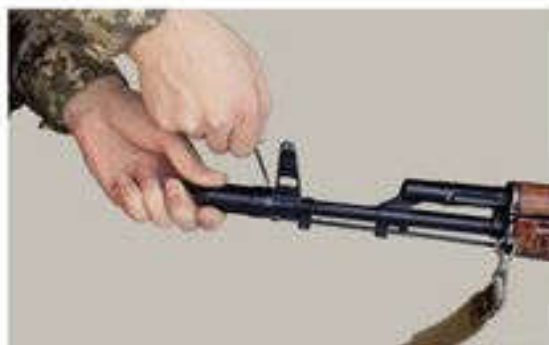
10, а-сурет. Автоматтан ұнғылық тежеуіш компенсаторын алу
