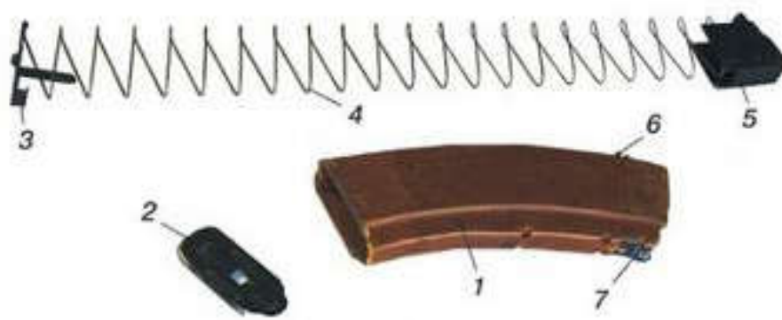
29-сурет. Оқжатар: 1 – корпус; 2 – қақпақ; 3 – тоқтатқыш қабылтыр; 4 – серіппе; 5 – бергіш; 6 – тірек шығыңқысы; 7 – ілгек
