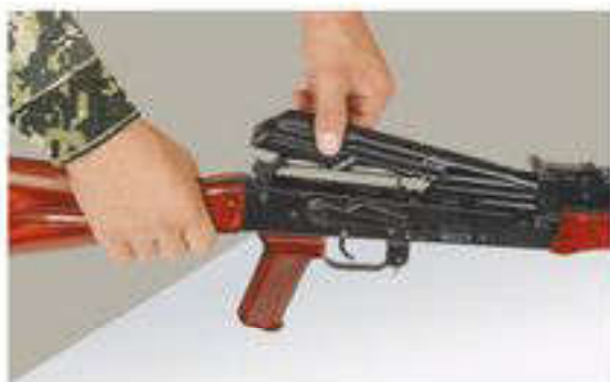
11, ә-сурет. Ұнғы қорабының қакпағын бөліп алу
