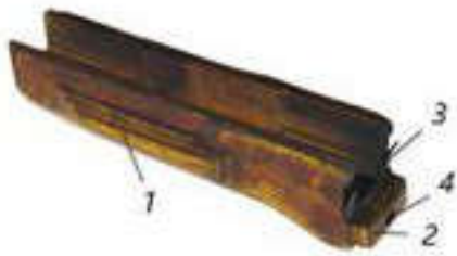
28-сурет. Құндақ (ағаш): 1 – саусақтарға арналған тіреу; 2 – шығыңқы; 3 – тілімшелі серіппе; 4 – сұмбіге арналған тесік
