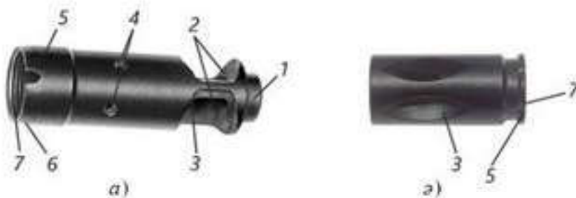
19-сурет. Ұңғылық тежеуіш-компенсатор және жалын сөндіргіш:
