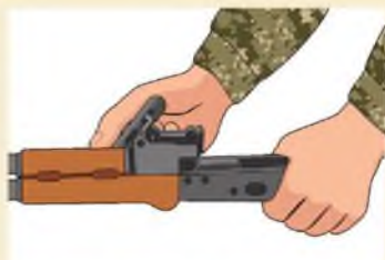
4.11-сурет. Көмекші жарақтың көмегімен газ түтігі тұйықтаушысын бұру
