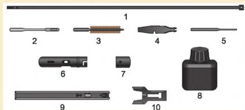
4.28-сурет. Керек-жарақтар: 1 – сүмбі; 2 – тазалағыш; 3 – сүрткіш; 4 – бұрағыш; 5 – қаққы; 6 – пенал; 7 – қақпақ; 8 – майсауыт; 9 – оқтізер; 10 – ұластырғы
