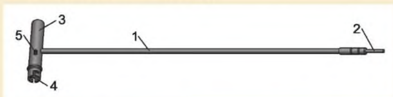
4.29-сурет. Автоматты тазалау үшін дайындалған керек-жарақтар: 1 – сүмбі; 2 – тазалағыш; 3 – пенал; 4 – бұрағыш; 5 – сүмбінің басы
