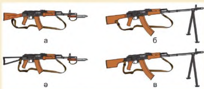
4.1-сурет. 5,45 миллиметрлік Калашников автоматы және қол оқшашары: а – дүмі тұрақты (АК-74); в – жиналмалы дүмі бар (АКС-74); б – дүмі тұрақты (РПК-74); г – дүмі жиналмалы (РПКС-74)
