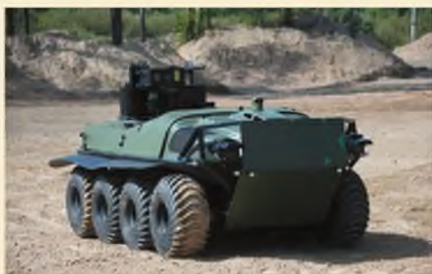
7.2-сурет. «Арго» роботтандырылған әскери кешені
