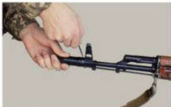
Рис. 10, а. Отделение у автомата дульного тормоза-компенсатора
