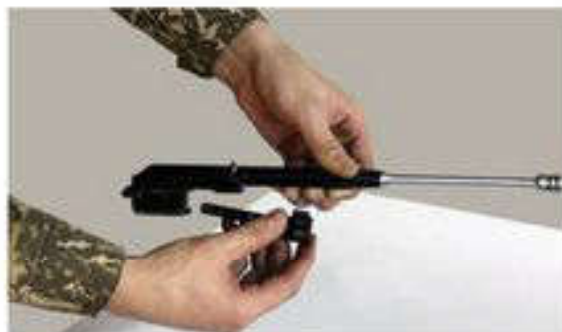
Рис. 14. Отделение затвора от затворной рамы
