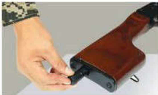
Рис. 16. Вкладывание пенала принадлежностей в гнездо приклада
