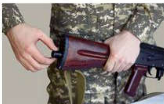
Рис. 8. Вынуть пенал принадлежностей из гнезда приклада
