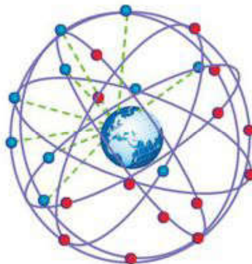
Рис. 61. Орбиты спутников системы GPS. Пример видимости спутников из одной из точек на поверхности Земли
