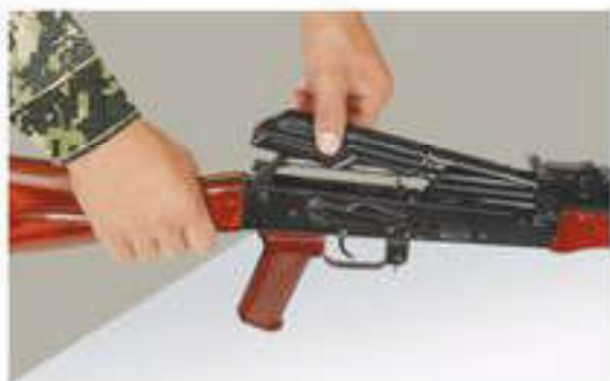
Рис. 11, б. Отделение крышки ствольной коробки
