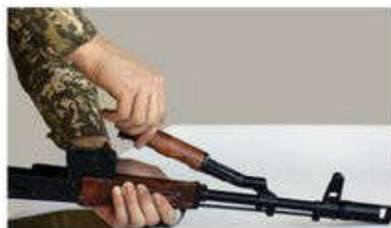
Рис. 15, б. Отделение газовой трубки со ствольной накладкой
