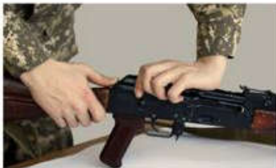
Рис. 11, а. Отделение крышки ствольной коробки
