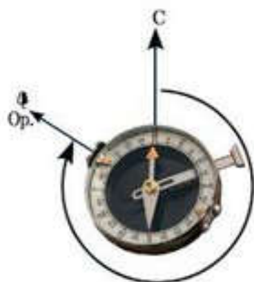
Рис. 83. Определение магнитного азимута по компасу. Магнитный азимут на ориентир 330^\circ
