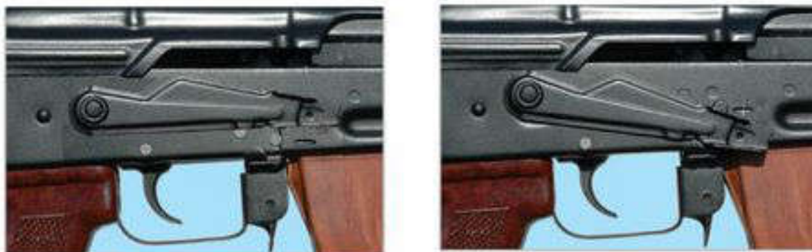
Рис. 46. Установка переводчика на необходимый вид огня: а — для ведения автоматического огня, б — для ведения одиночного огня
