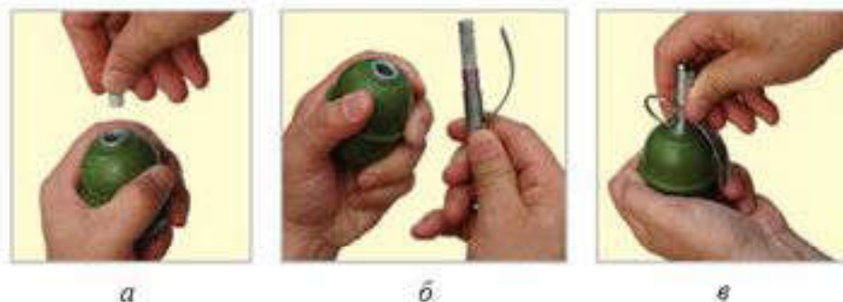
Рис. 57. Заряжание ручной осколочной гранаты:
