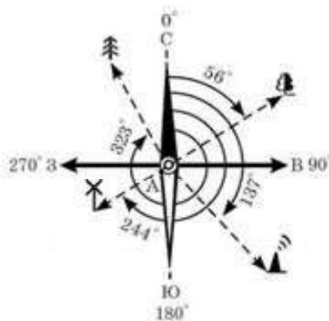
Рис. 84. Магнитные азимуты: на лиственное дерево — 56^\circ ; на фабричную трубу — 137^\circ ; на мельницу — 244^\circ ; на ель — 323^\circ
