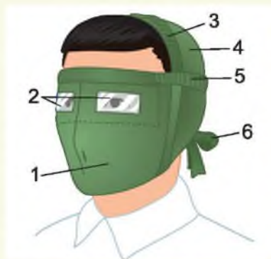
Рисунок 8.11. Противопыльная тканевая маска: 1 – корпус маски; 2 – смотровые отверстия; 3 – крепление; 4 – резиновая тесьма; 5 – поперечная резинка; 6 – завязки
