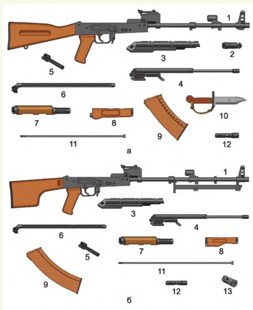
Рисунок 4.2. Основные части и механизмы: а – автомата; б – пулемета; 1 – ствол со ствольной коробкой, ударно-спусковым механизмом, прицельным приспособлением, прикладом и пистолетной рукояткой, а у пулемета – и с сошкой; 2 – дульный тормоз-компенсатор; 3 – крышка ствольной коробки; 4 – затворная рама с газовым поршнем; 5 – затвор; 6 – возвратный механизм; 7 – газовая трубка со ствольной накладкой; 8 – цевьё; 9 – магазин; 10 – штык-нож; 11 – шомпол; 12 – пенал с принадлежностью; 13 – пламегаситель
