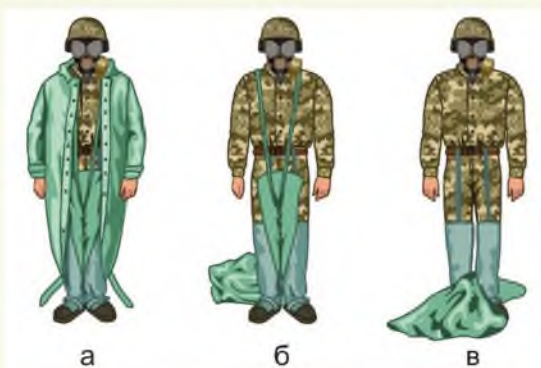
Рисунок 1.5. Приемы снятия общевойскового защитного комплекта в виде комбинезона: а, б, в – последовательность действий
