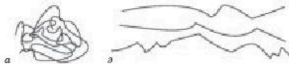
28-сурет. Изопрен көксағыздың макромолекуласы: а — қыздырғанға дейін; б — қыздырғаннан кейін
