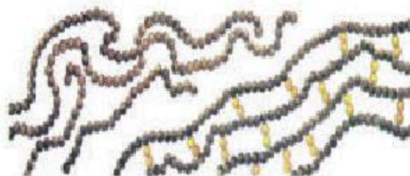
29-сурет. Вулканизацияланған көксағыздың құрылыс сызбасы
