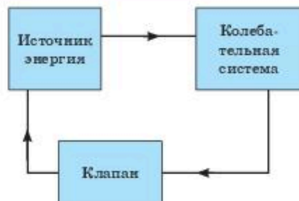
Рис. 3.2. Основные элементы автоколебательной системы
