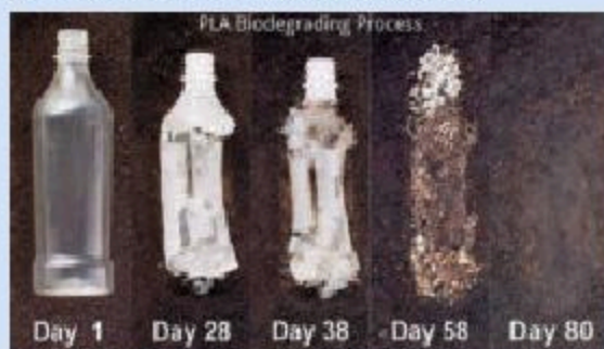
Рис. 93. Разложение одноразовой посуды из биоразлагаемого синтетического полимера — полимолочной кислоты
