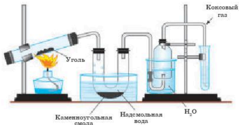
Рис. 48. Лабораторный опыт коксования каменного угля
