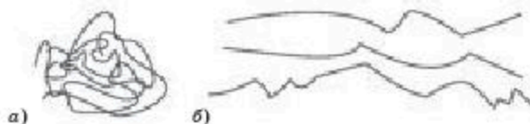
Рис. 28. Макромолекулы изопренового каучука: а) до нагревания; б) после нагревания
