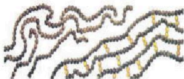
Рис. 29. Схема строения вулканизированного каучука
