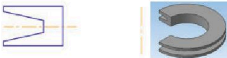
Рис. 8.3. Эскиз и элемент, образованный операцией вращения
