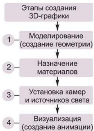
Рисунок 5.7 Схема этапов создания 3D-модели
