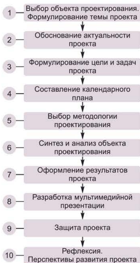
Рисунок 15.2 Схема этапов процесса проектирования
