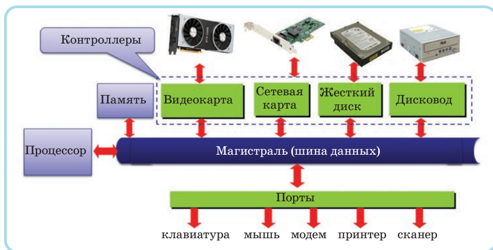
Рис. 2. Схема взаимодействия компьютерных устройств
