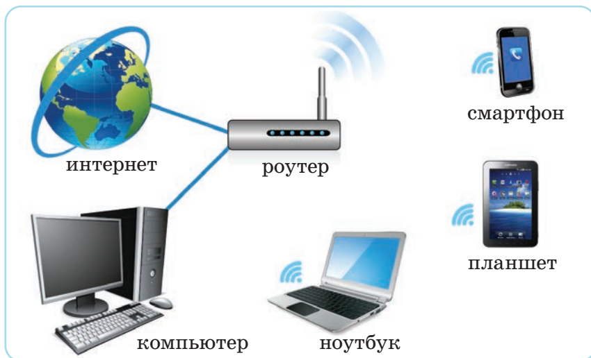
Рис. 6. Схема подключения беспроводной сети Wi-Fi в домашних условиях
